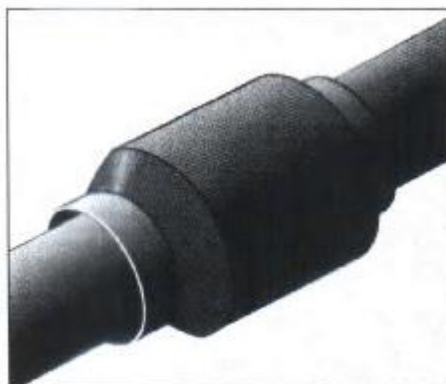
Рисунок В.2 – Установка термоусадочной муфты
