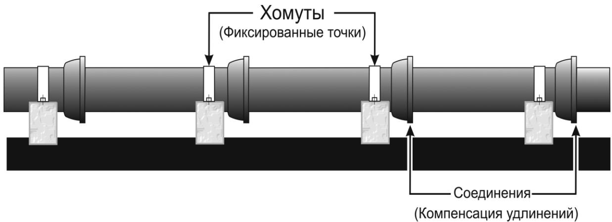
Рисунок 6.15 Компенсация расширений.
