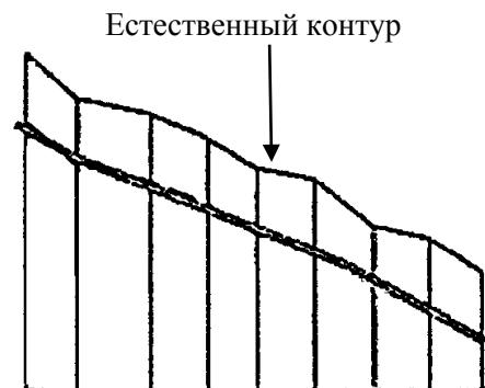
Рисунок 5.5 Трубопровод с постоянным уклоном.
