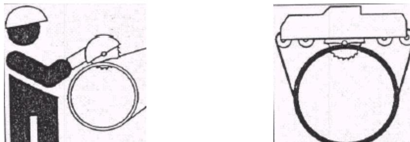
Рисунок 7.2 Резка трубы.
