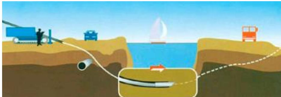
Рисунок 6.18 Бурение пилотной скважины.
