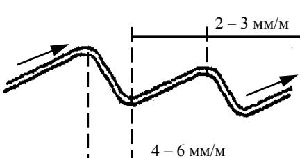
Рисунок 5.6 Трубопровод с переменным уклоном.
