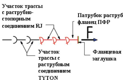
Этот метод состоит в фиксации (укреплении) необходимого количества соединений с каждой стороны отвода в целях использования сил трения между трубой и грунтом для компенсации сил гидравлического осевого давления
