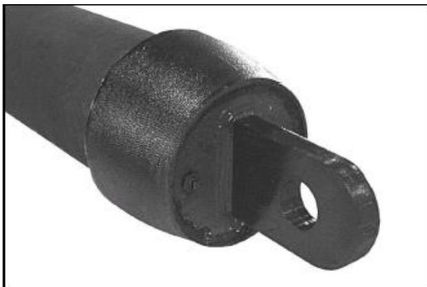
Рисунок 6.21 Приспособление для протягивания труб.
