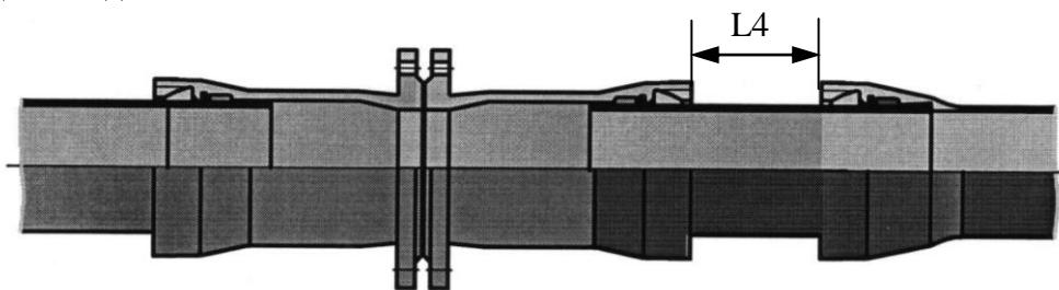
Рисунок 7.7 Ремонт трубопровода при помощи патрубков фланец-раструб.
