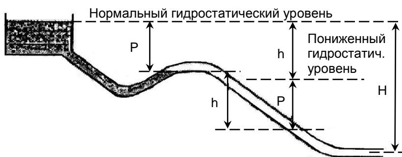
Рисунок 5.3 Условия в гравитационном трубопроводе.
