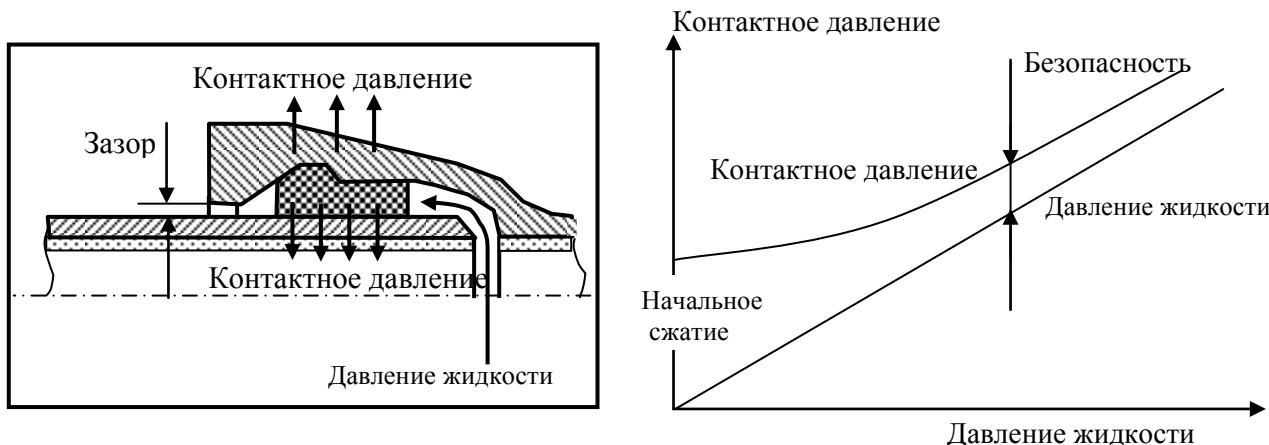
Рисунок 2.14 Контактное давление.
