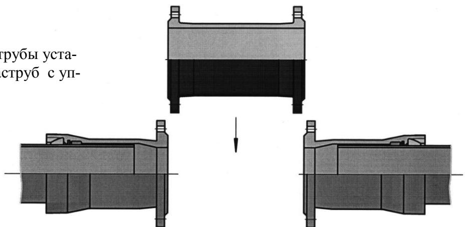
Между двух установленных патрубков фланец-раструб вставить фланцевый патрубок с уплотнительными кольцами. Фланцы соединить болтами.
