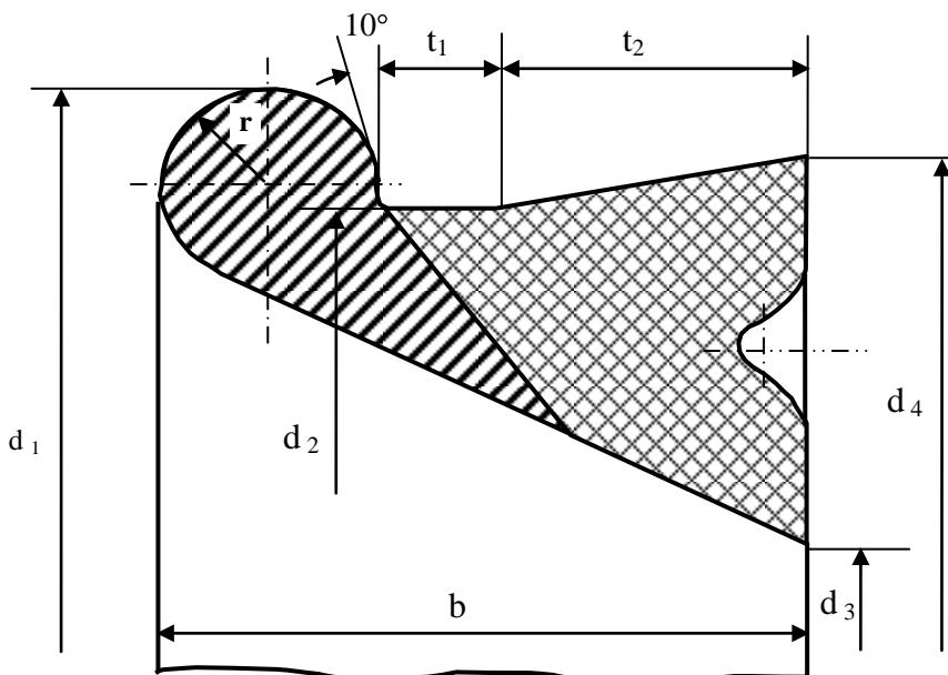
Рисунок 2.6 Уплотнительное резиновое кольцо под соединение типа «RJ».
