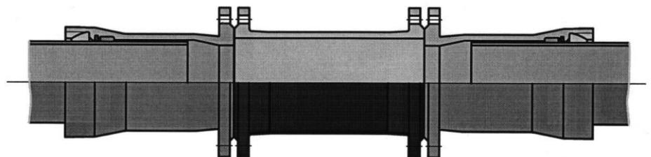
Рисунок 7.6 Ремонт трубопровода при помощи фланцевого патрубка и патрубков фланец-раструб.
