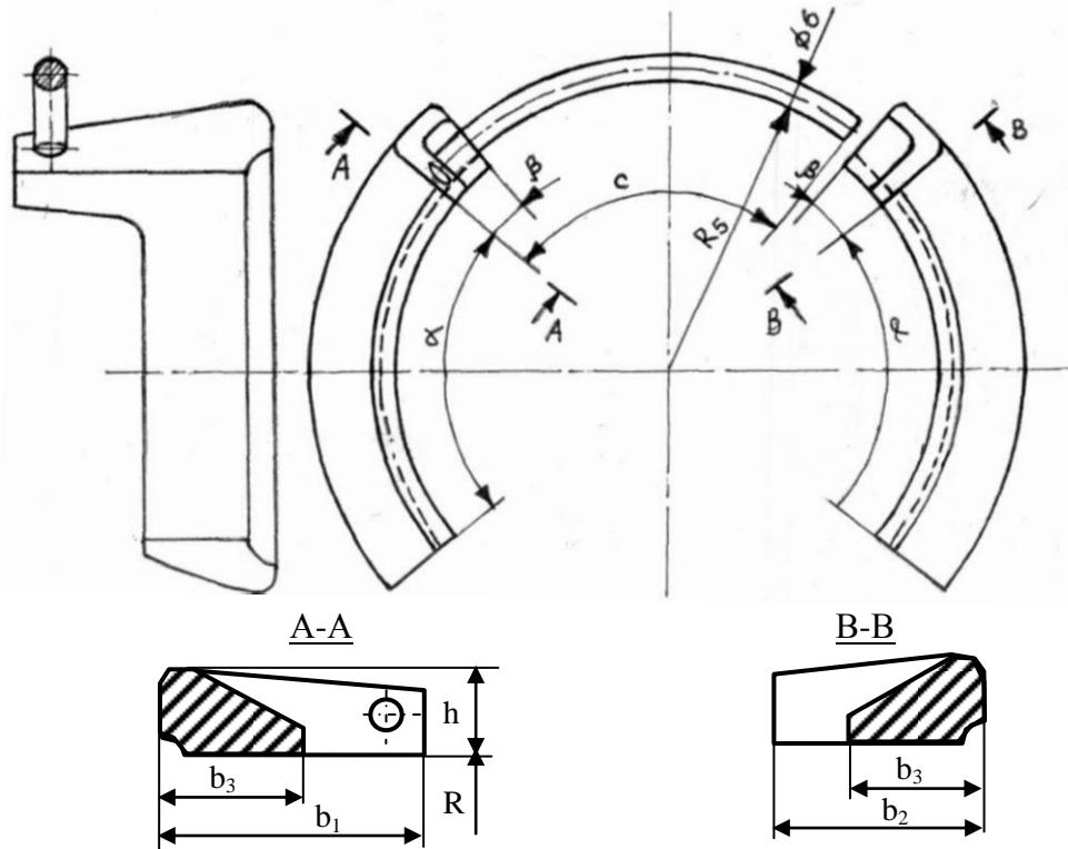
Рисунок 2.7 Стопор из ВЧШГ под соединение «RJ».
