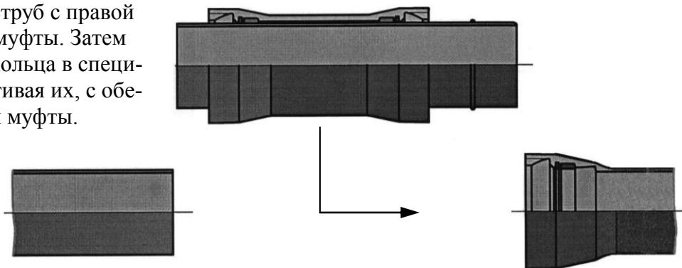
Участок трубы с надвижной муфтой установить в раструб трубы с правой стороны трубопровода и закрепить соединение стопорами. Вставить в раструб (с левой стороны надвижной муфты) уплотнительное кольцо. Надвижную муфту передвинуть влево на расстояние L3. Установить в раструбы надвижной муфты стяжные кольца и затянуть их.
