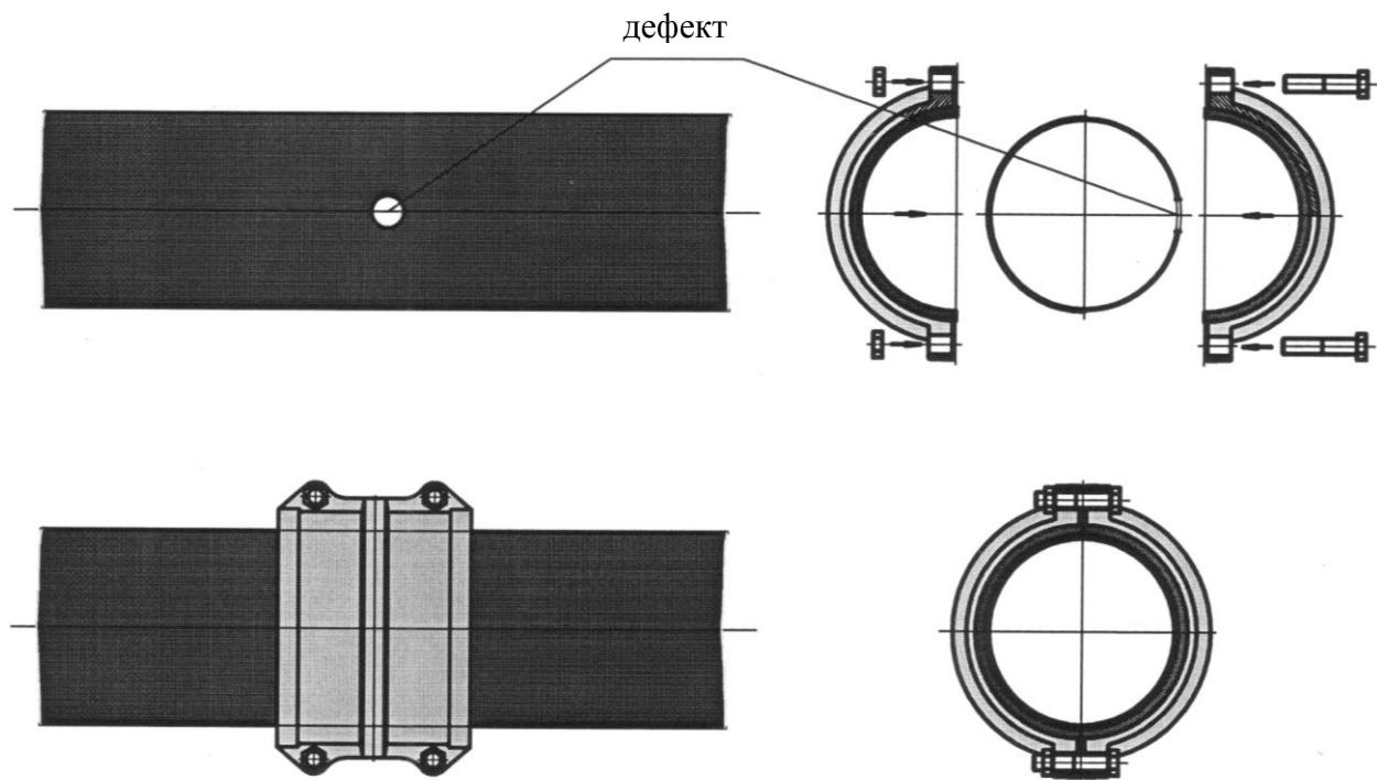
Рисунок 7.9 Ремонт трубопровода при помощи муфты свёртной.
