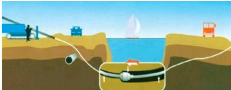
Рисунок 6.19      Расширение скважины.
