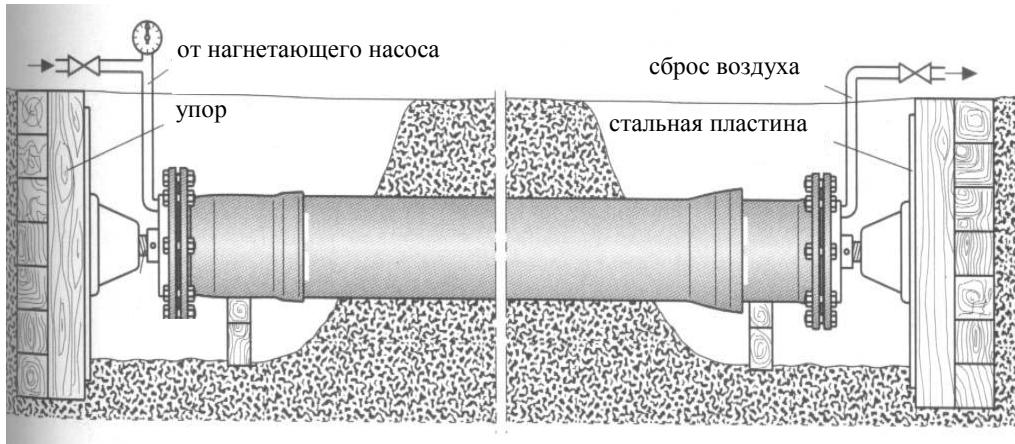
Рисунок 6.34 Гидравлические испытания трубопровода.
