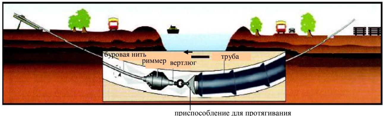
Рисунок 6.20      Протягивание трубопровода.
