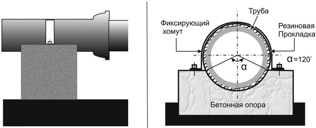
Рисунок 6.14 Крепление трубопровода к опорам.
