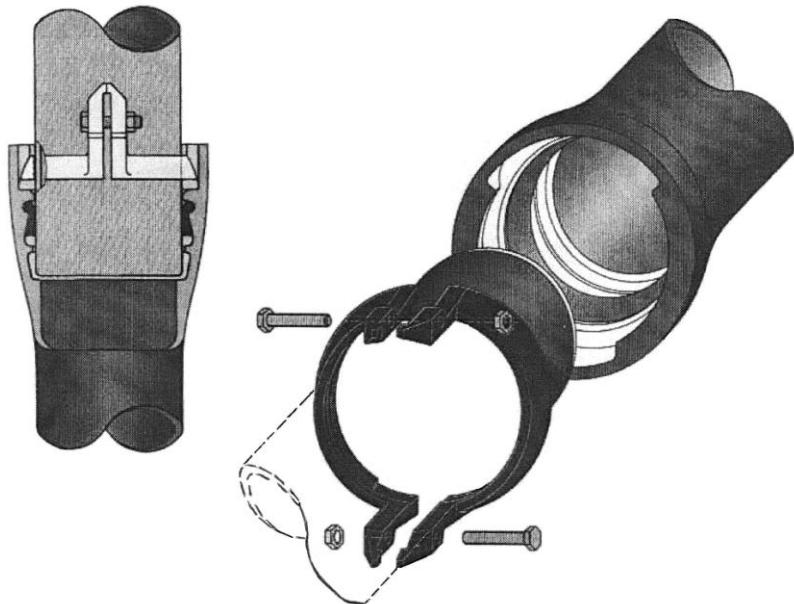
Рисунок 6.10 Специальное приспособление – стяжные кольца, заменяющее наплавленный валик.
