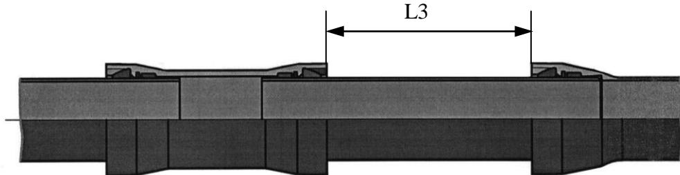
Рисунок 7.8 Ремонт трубопровода при помощи надвижной муфты.
