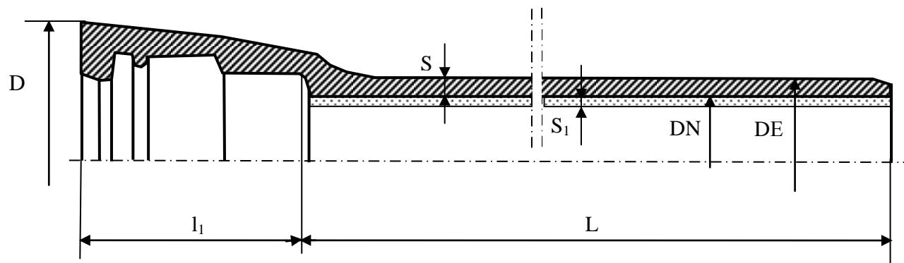
Рисунок 2.2 Труба раstrубная под соединение «Tytom».
