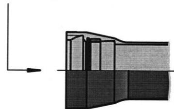
Участок трубы с патрубком фланец-раструб установить в раструб трубы с правой стороны трубопровода. Патрубок фланец-раструб передвинуть влево на длину L4. Патрубок фланец-раструб (на левом участке трубопровода) передвинуть вправо, установить между фланцами уплотнительные кольца и соединить их болтами.
