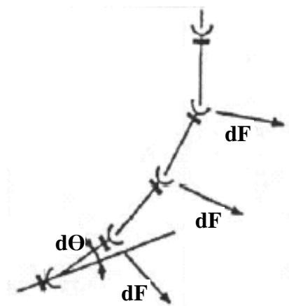
Рисунок 6.16 Гидравлические силы, возникающие при смещении труб.
