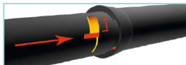
6. Установка левого стопора с фиксацией стопорной проволоки
