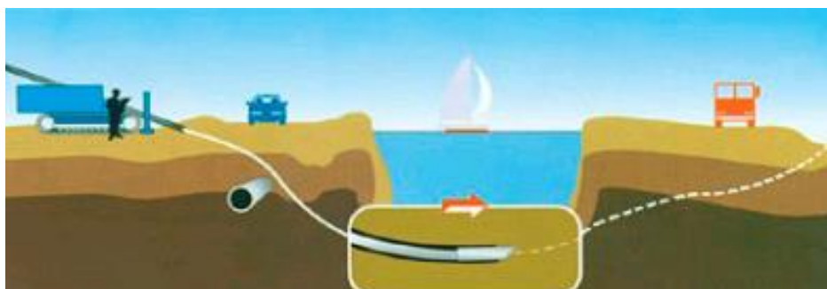
Рисунок 17.1 Бурение пилотной скважины
