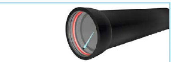
6. Смазка внутренней поверхности уплотнительного кольца
