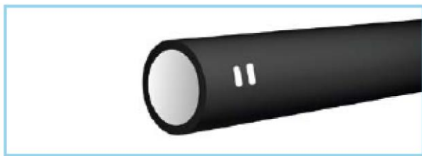
2. Нанесение специальной метки на гладком конце трубы
