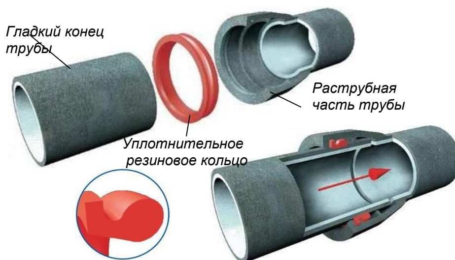
Рисунок 5.1 Раструбное соединение «TYTON».
