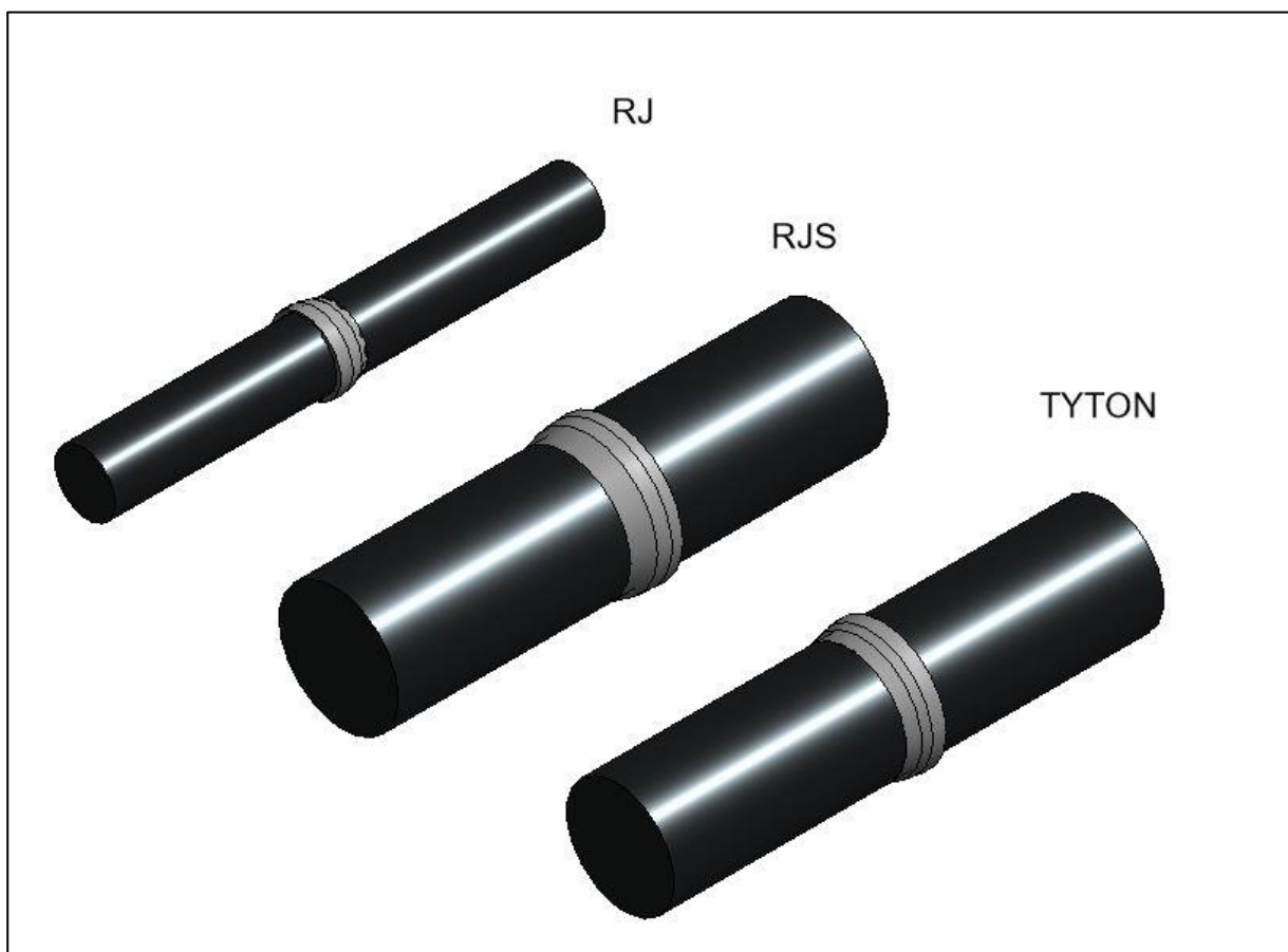
Рисунок 2 Пример изображения труб с соединениями «TYTON», «RJS», «RJ»
