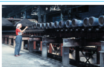
6. Участок нанесения цементно-песчаного покрытия
