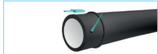
1. Очистка и смазка гладкого конца трубы
