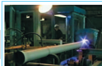
5. Участок нанесения цинкового покрытия
