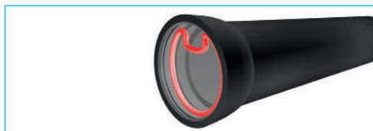
5. Установка уплотнительного кольца в раструб
