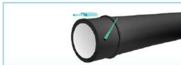
1. Очистка и смазка гладкого конца трубы
