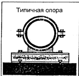
Рисунок 6.32 Трубопровод, закрепленный на сооружении.
