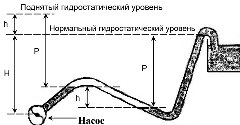
Рисунок 5.4 Условия в напорном трубопроводе.
