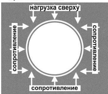
Механические характеристики заложенной в грунт трубы могут быть оценены через рассмотрение системы взаимодействия «труба/грунт»: взаимодействие труб с окружающим грунтом зависит от их жесткости или гибкости, которые, в свою очередь, характеризуют возникающие напряжения при различных условиях за-кладки.
