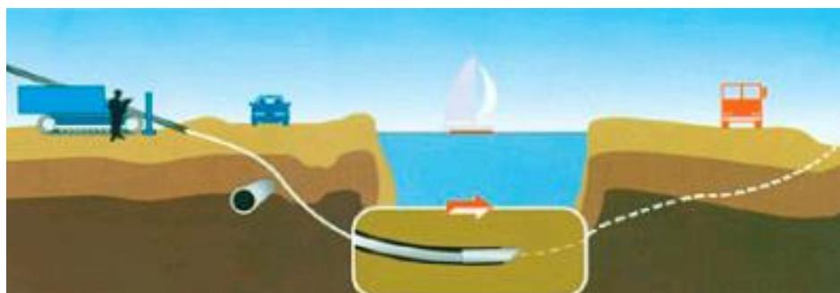
Рисунок 6.18 Бурение пилотной скважины.
