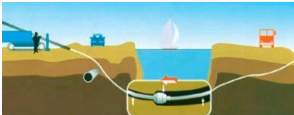
Рисунок 6.19      Расширение скважины.
