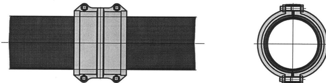
Рисунок. Ремонт трубопровода при помощи муфты свёртной МС.
