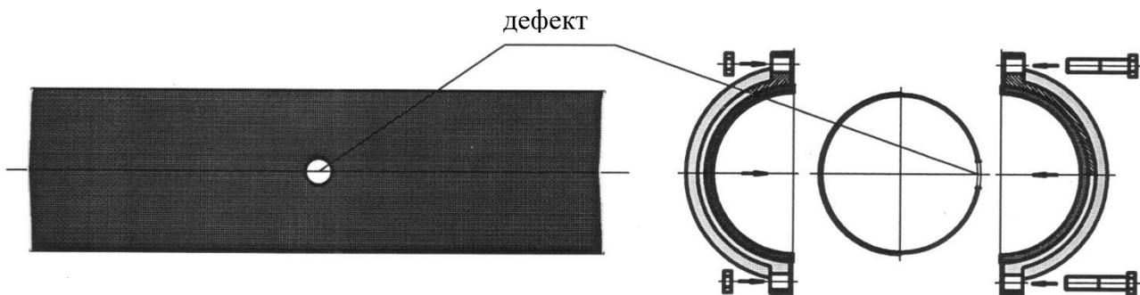
Установить, с двух противоположных сторон трубы, на дефект половинки корпуса муфты с уплотнителями и соединить болтами. При установке муфты дефект должен располагаться по центру уплотнителя.
