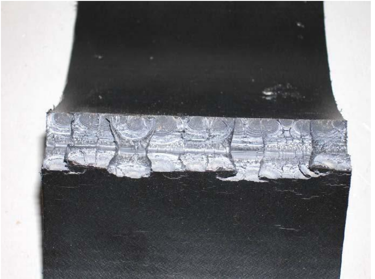
Снимок 14. Трещины на поверхности. Образец из Окое.
