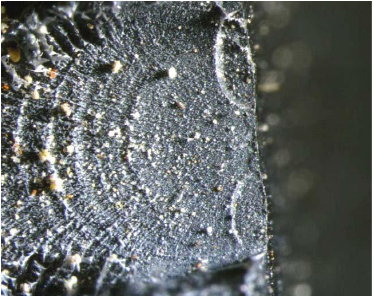
Снимок 16. Увеличенное изображение поверхности разрушения, показывающее медленный рост трещин.
