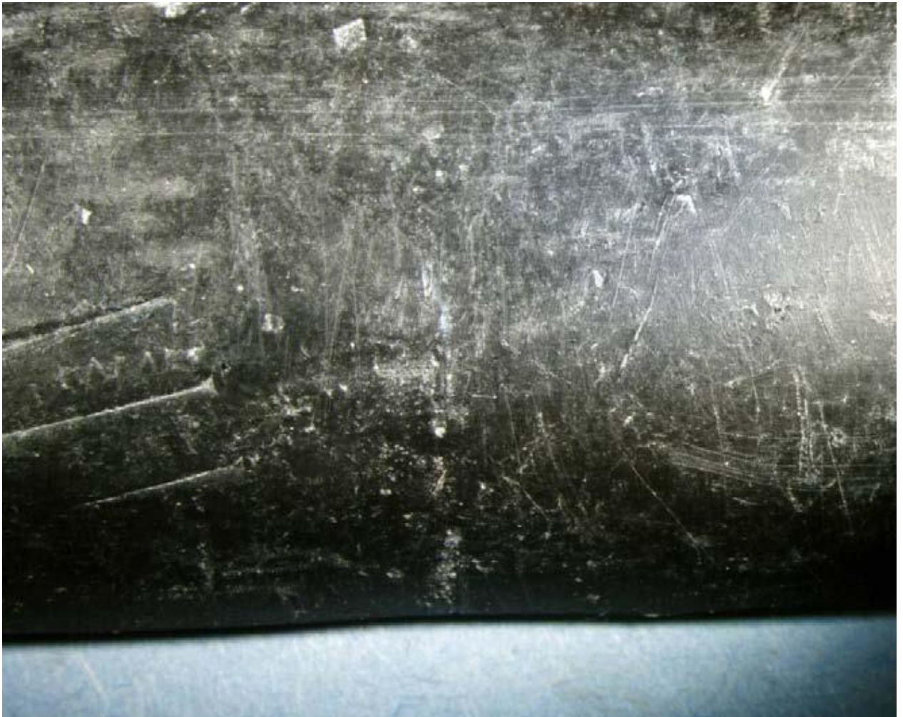
Снимок 3. Сдавленный участок рядом с местом прорыва.
