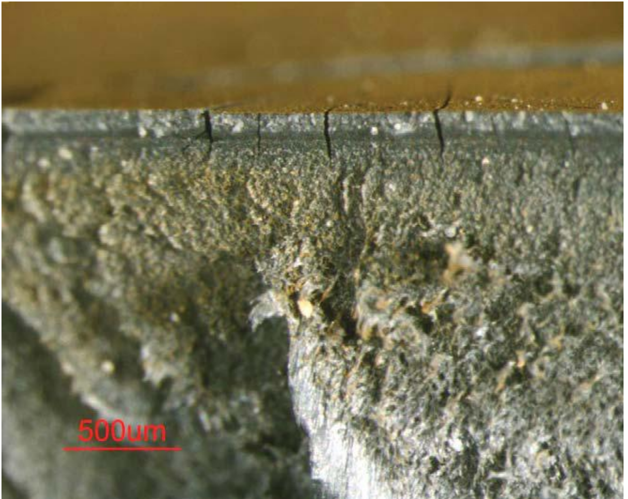
Снимок 10. Поверхность излома рядом с трещиной, хрупкая поверхность слоя.
