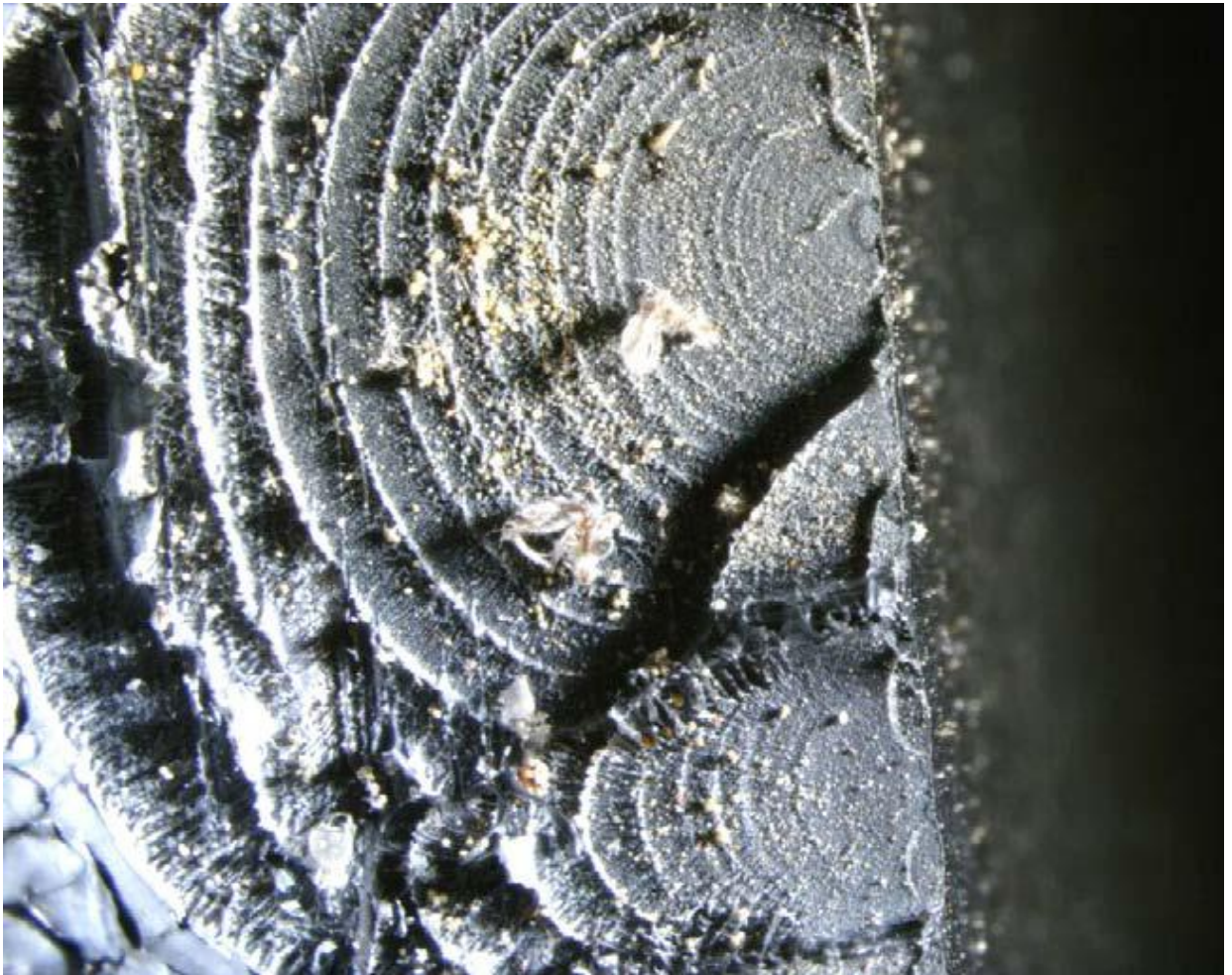
Снимок 15. Поверхность разрушения. Многочисленные образования трещин и их медленный рост.
