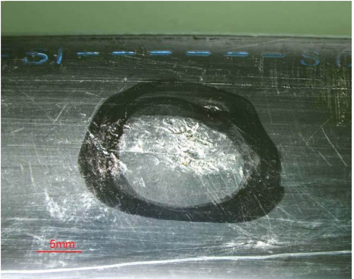
Снимок 26. Место повреждения на наружной поверхности трубы. Бейкерсфилд, Калифорния.
