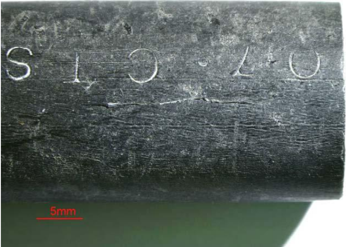
Снимок 29. Образец с продольной трещиной. Гамильтон, Огайо.
