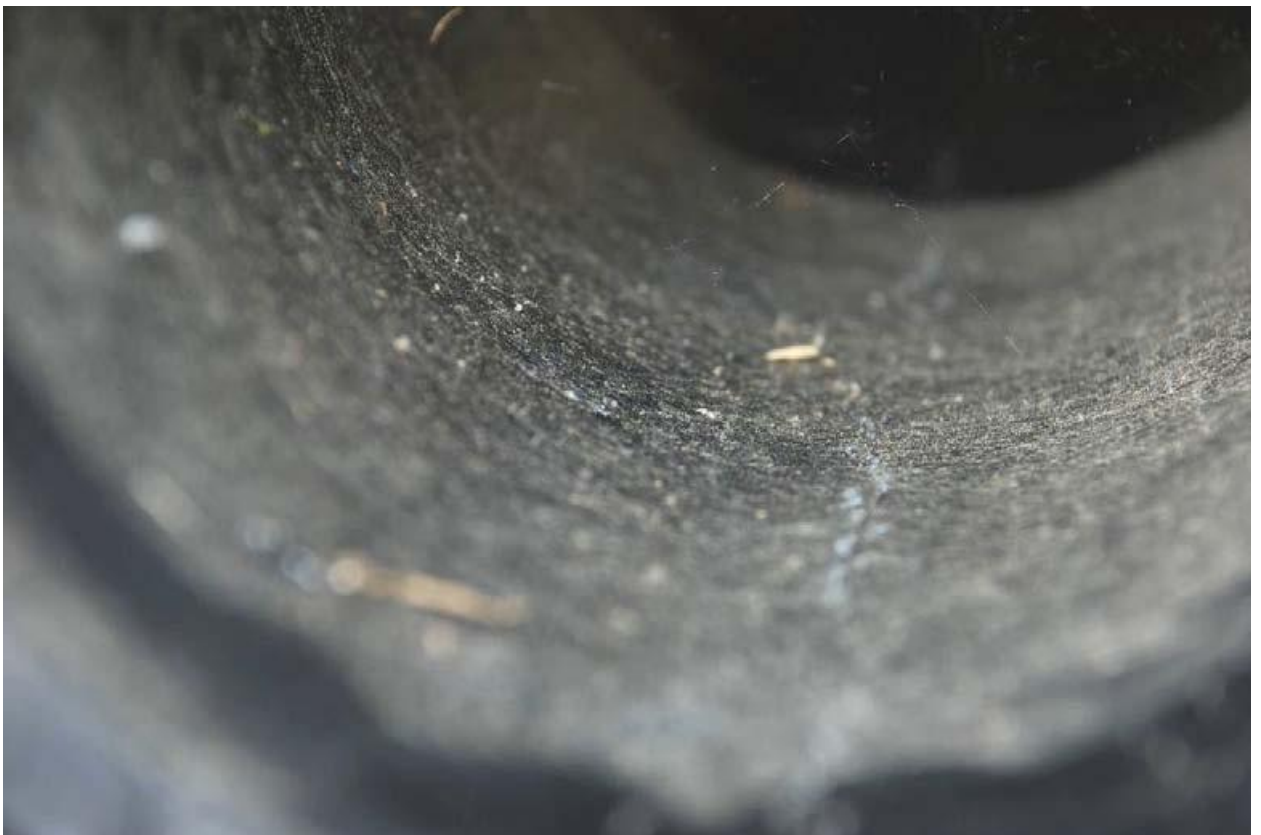
Снимок 12. Трещина по внутреннему диаметру на образце из Окое.
