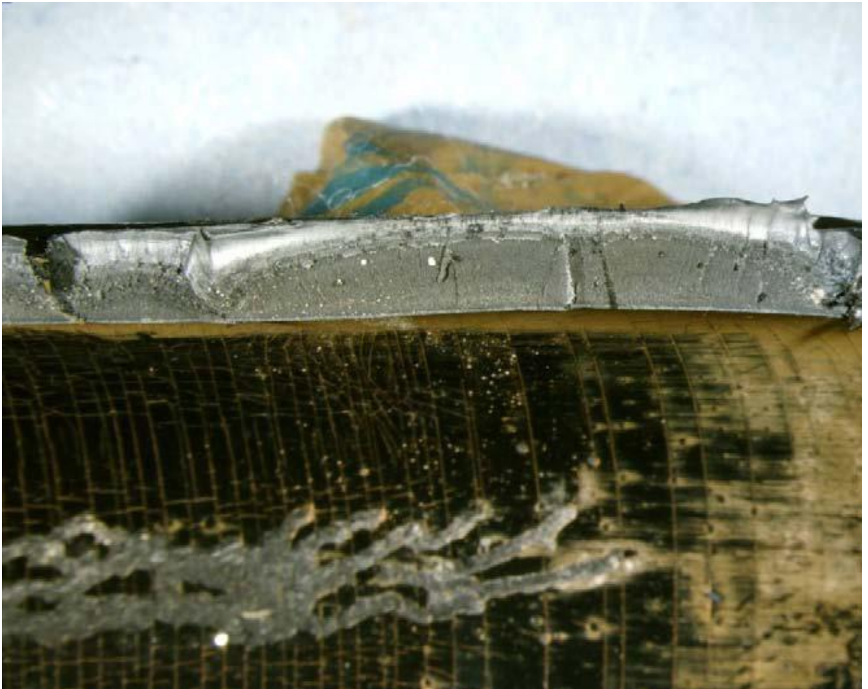
Снимок 8. Поверхность излома с большим количеством трещин. Внутренняя поверхность трубы.
