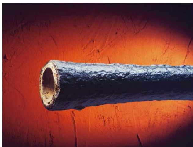
Рис.7 Чугунная труба из замка Dillenburg проработавшая до 1760 года
