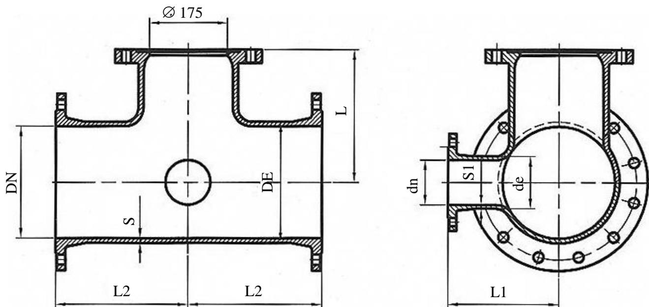
Рисунок 12.31 – Тройник фланцевый с пожарной подставкой – ППТФ.
