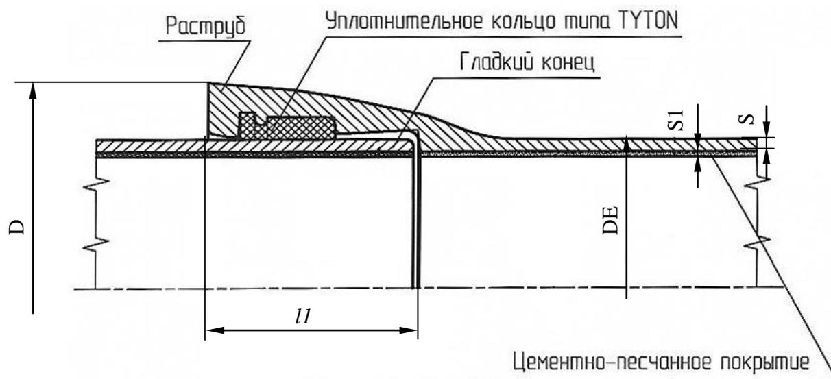
Рисунок 12.1 – Раструбное соединение «TYTON».
