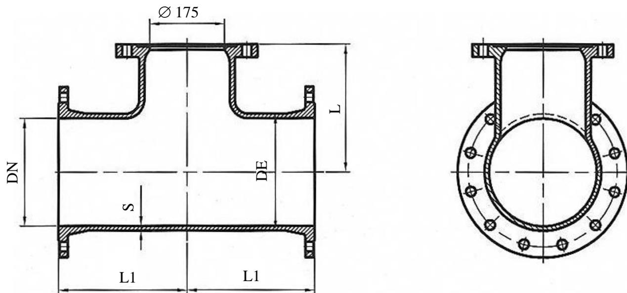
Рисунок 12.29 – Пожарная подставка фланцевая – ППФ.
