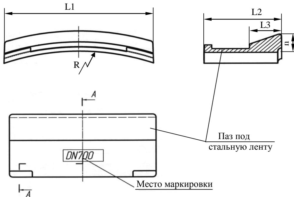
Рисунок 12.7 – Стопорный элемент из ВЧШГ для соединения «RJS».
