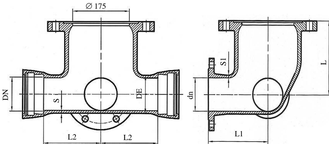
Рисунок 12.30 – Тройник раструб-фланец с пожарной подставкой – ППТРФ.
