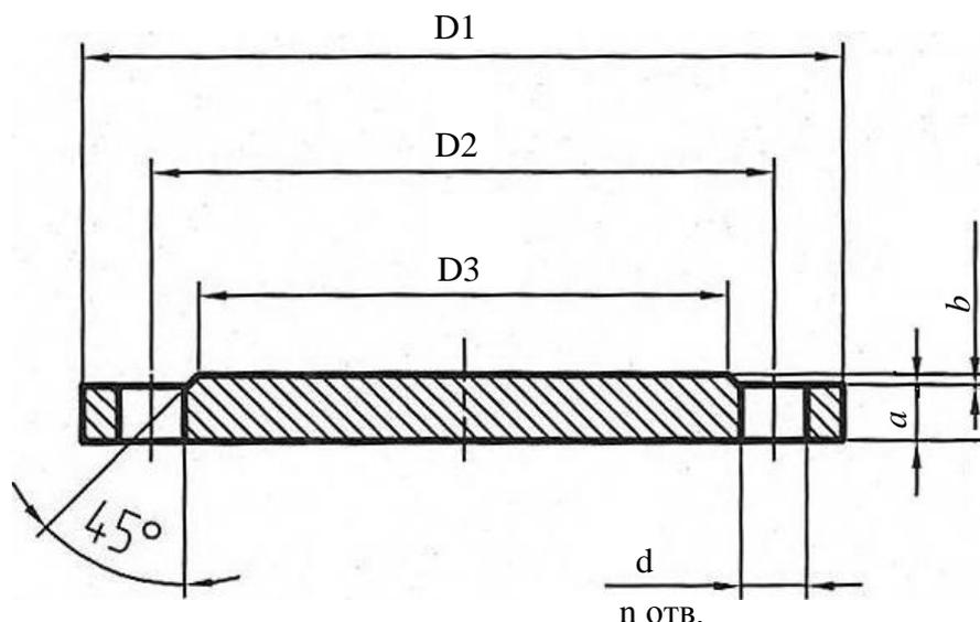
Рисунок 12.39 – Заглушка фланцевая – 3Ф.
