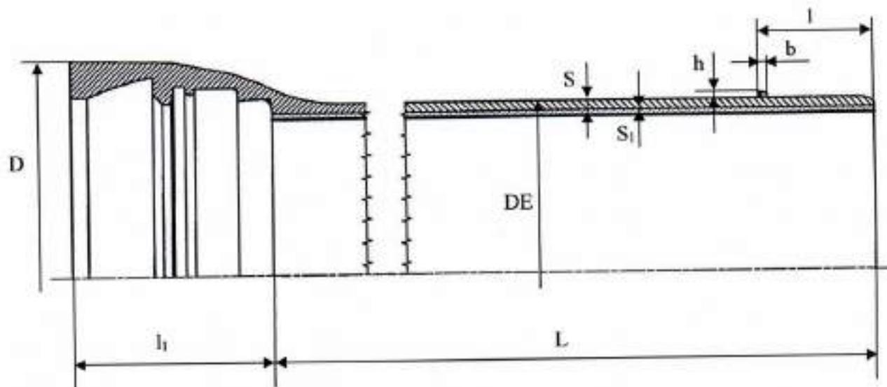
Рисунок А.7 – Труба раструбная с соединением «RJS».
