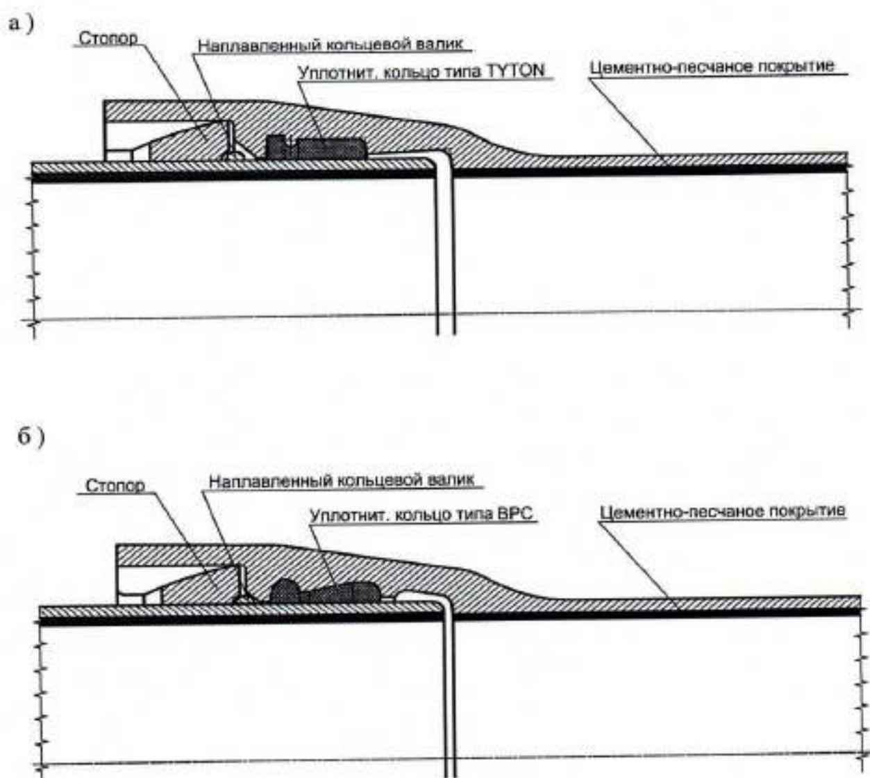
Рисунок А.3 – Раструбно-замковое соединение «RJ»: с уплотнительным резиновым кольцом типа «TYTON»; б) – с уплотнительным резиновым кольцом типа «ВРС».
