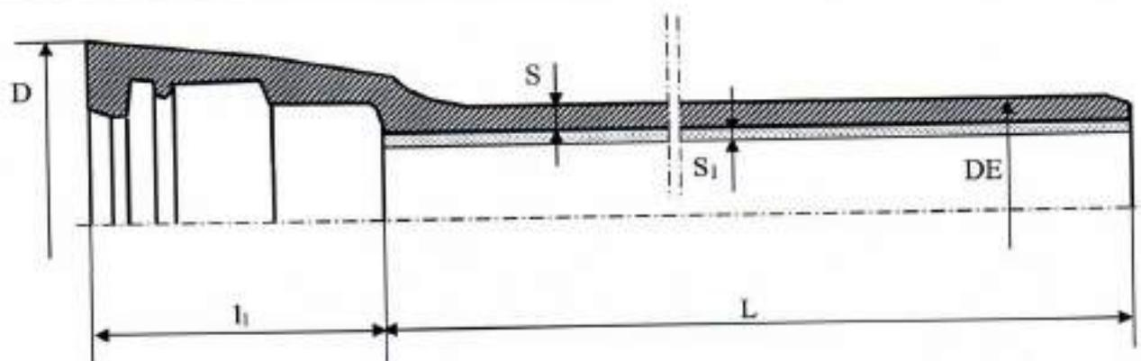
Рисунок А.5 – Труба раструбная с соединением «TYTON».
