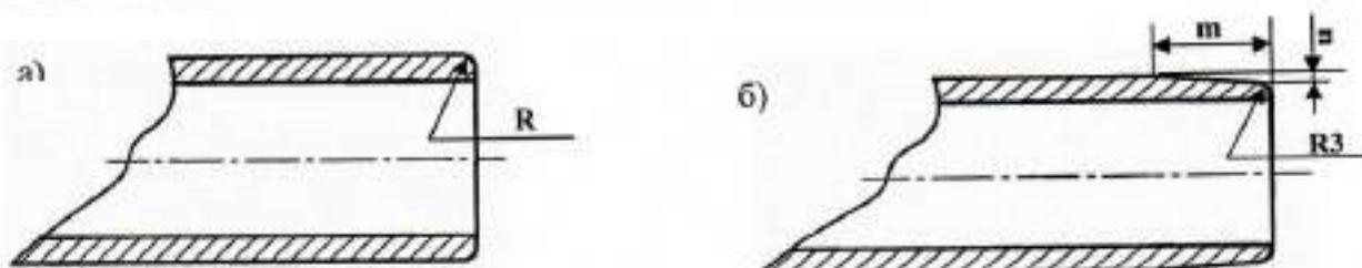
Рисунок А.9 – Торец гладкого конца трубы: а) радиус;
