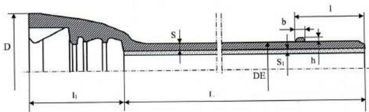
Рисунок А.6 – Труба раструбная с соединением «RJ».
