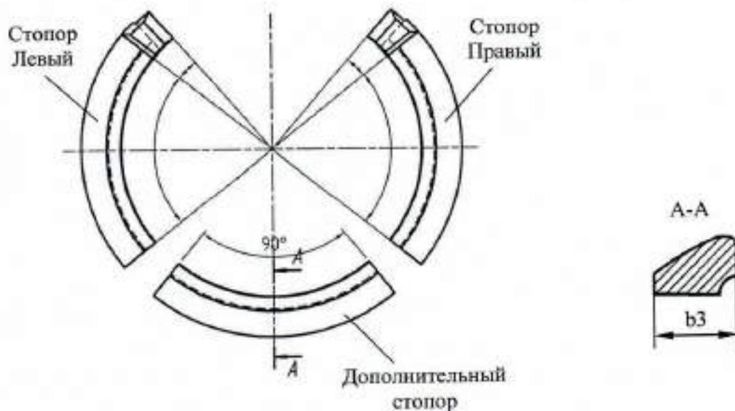
Рисунок А.10.2 – Дополнительный стопор из ВЧШГ для соединения «RJ» DN200 и DN250 PFA 64 бар.
