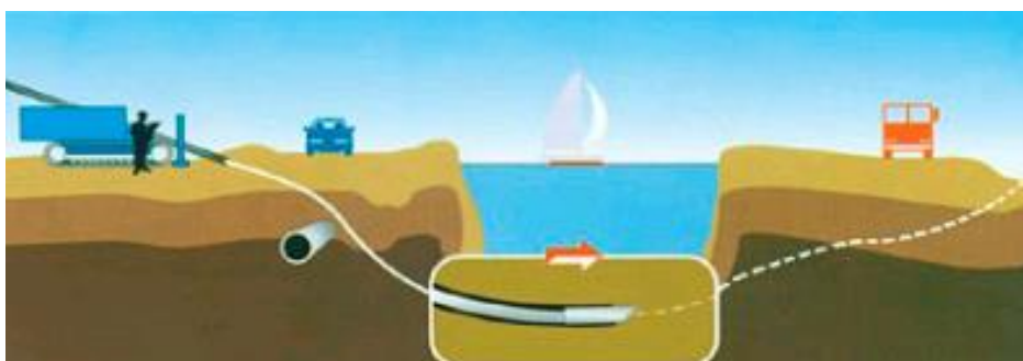
Рисунок 6.18 Бурение пилотной скважины.
