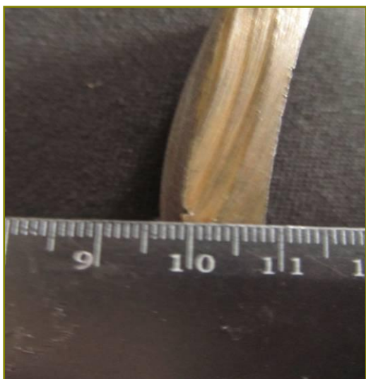
Рисунок Д.2 – Газовая шероховатость
