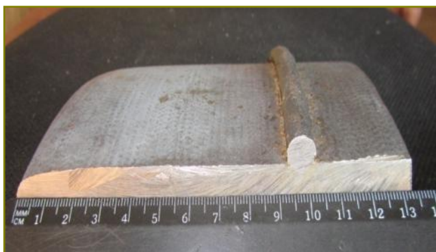
Рисунок Д.7 – Утонение гладкого конца трубы
