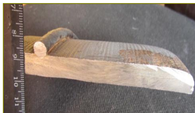
Рисунок Д.7 – Утонение гладкого конца трубы
