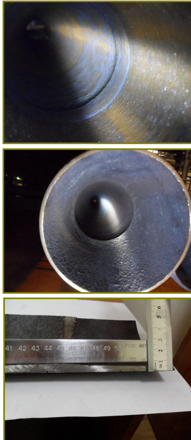
Рисунок Д.10 – Нарост, залив, грубая поверхность
