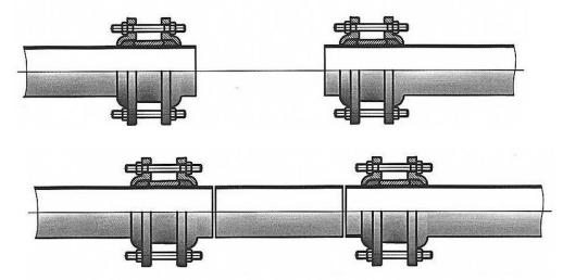
Переместить MPH так, чтобы стыки труб были посередине (между резиновыми уплотнителями) и затянуть гайки на шпильках.
