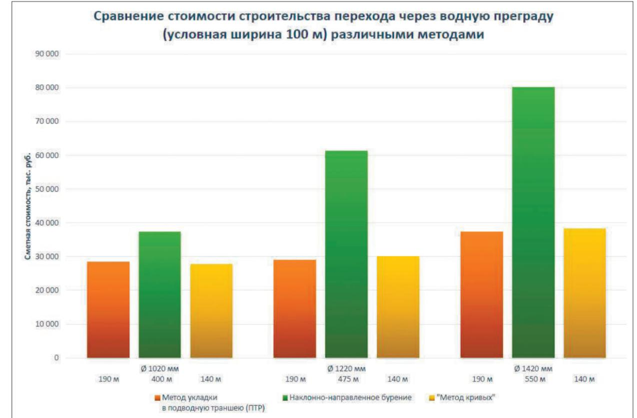
При применении «Метода кривых» и, соответственно, сокращении длины перехода русловой части, добавляются работы по открытой подземной укладке береговых участков трубопровода.
