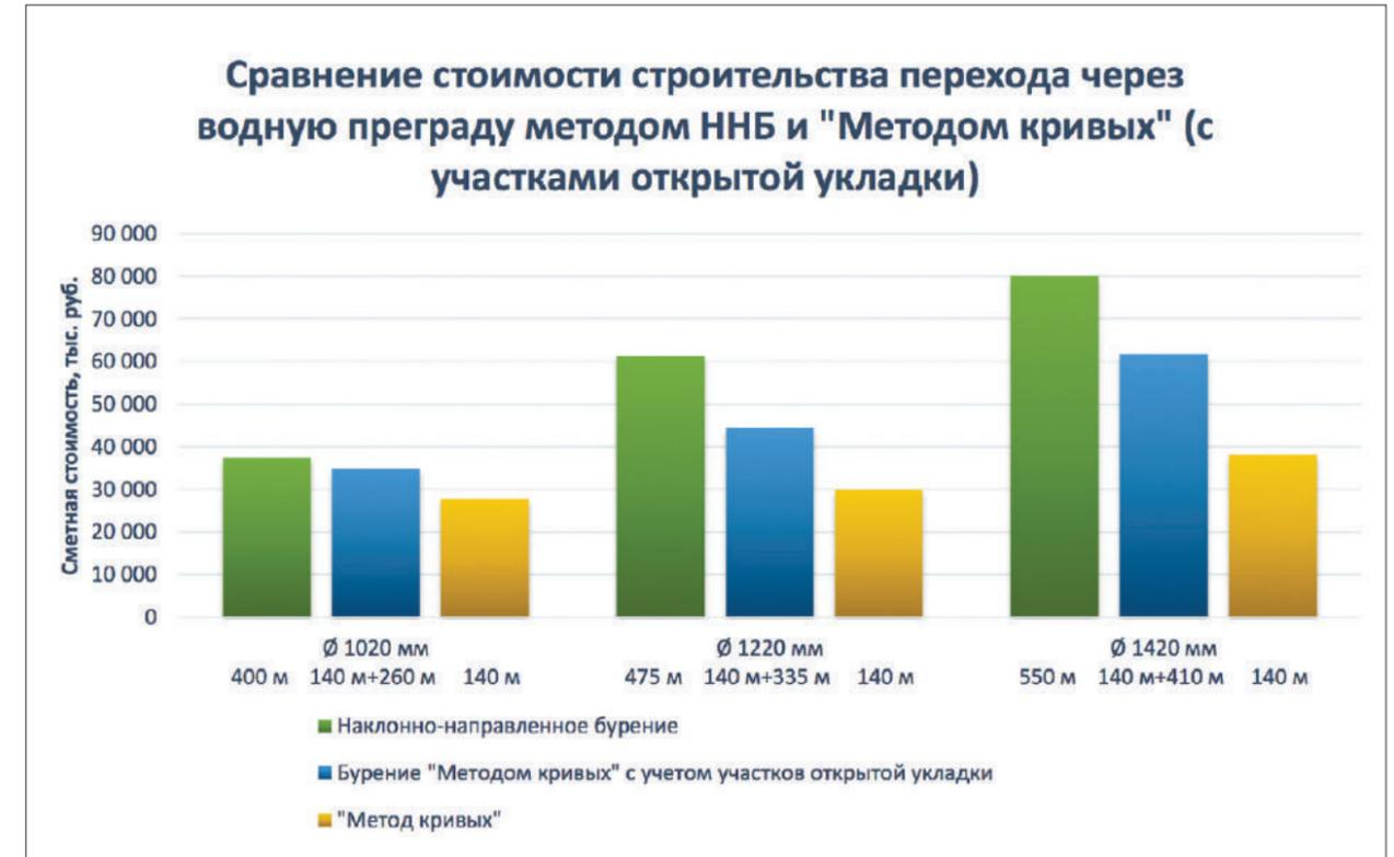
При применении «Метода кривых» и, соответственно, сокращении длины перехода русловой части, добавляются работы по открытой подземной укладке береговых участков трубопровода.
