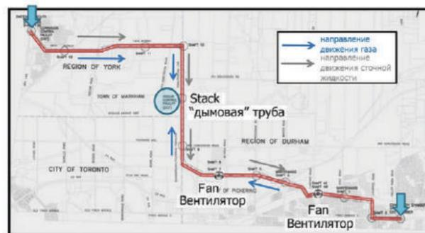
ственная тяга, которая усиливается за счет сооружения специальной «дымовой» трубы.
