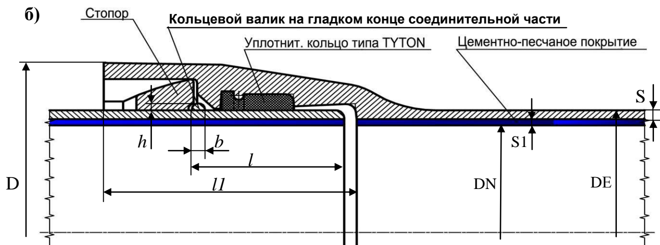
Рисунок А.1 – Раструбное соединение «RJ»: а) – с уплотнительным резиновым кольцом типа «ВРС»; б) - уплотнительным резиновым кольцом типа «TYTON».
