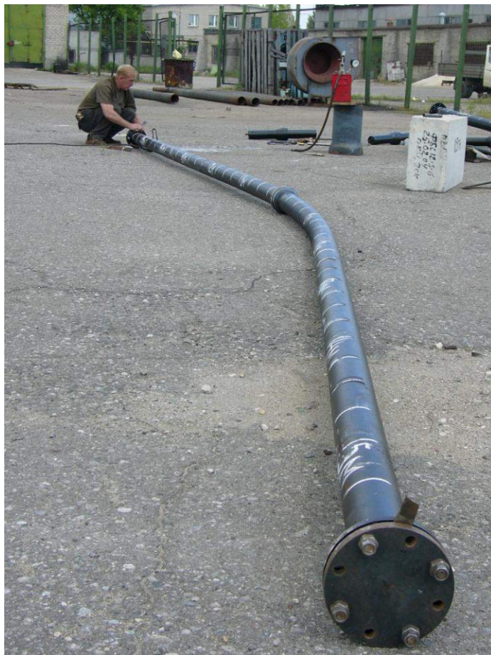
Рисунок 6 – Плеть с соединением “RJ” после испытаний на внутреннее давление и изгиб.
